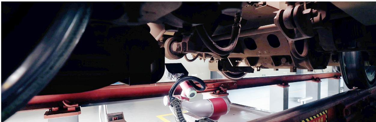
在铁路领域，盘古大模型结合巡检机器人，可精准识别一列动车的3.2万个点，覆盖8大类、350多种复杂故障，帮助高铁提升运营效率，降低成本。
